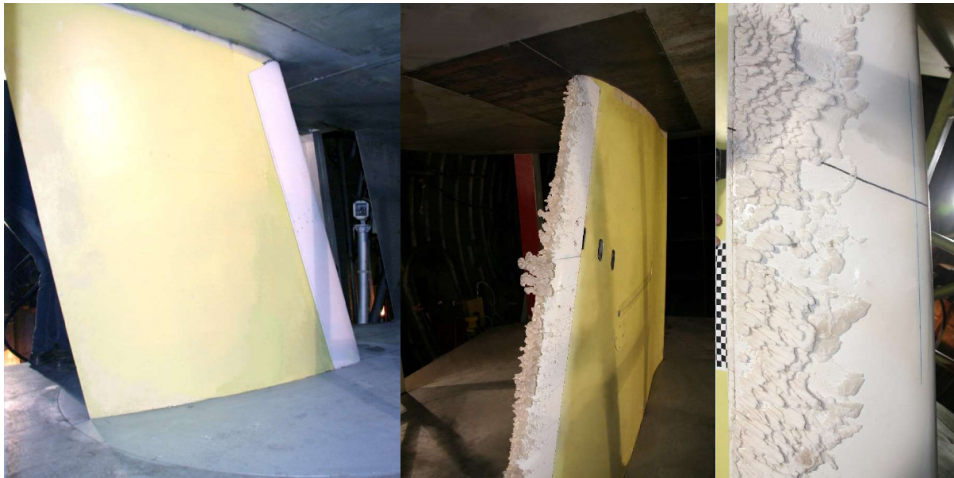
Ледяные наросты на поверхности секции крыла
